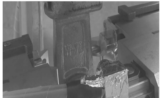
图 13 碗头挂板的定位效果图
