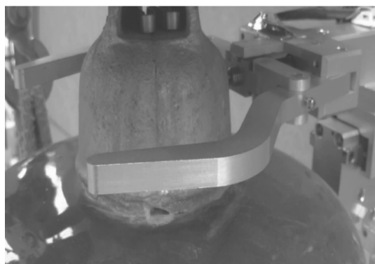
图 14 绝缘子串钢帽的定位效果图
